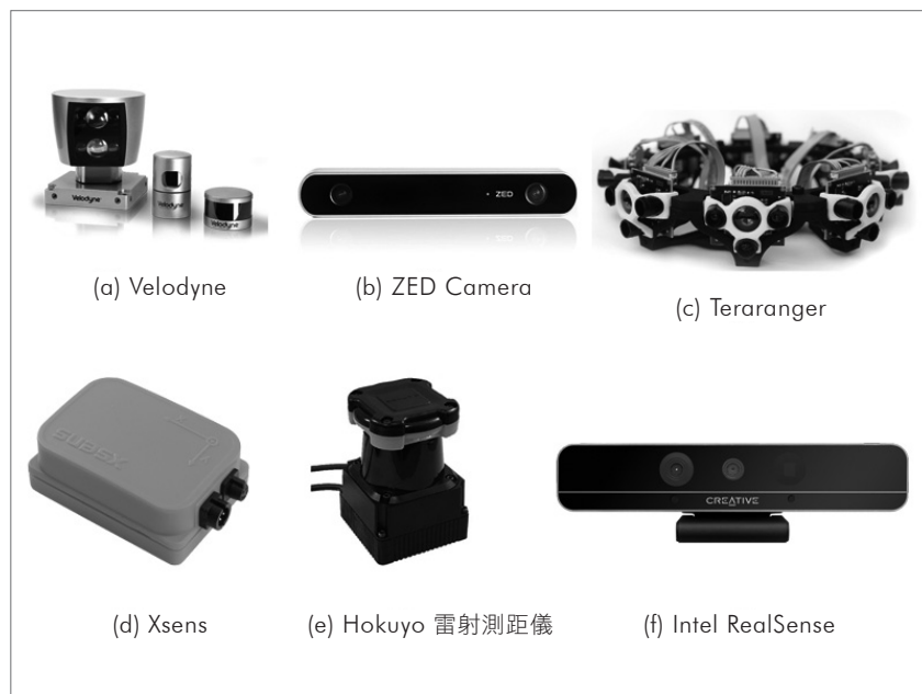
圖 1-5 支援 ROS 的常用機器人感測器
