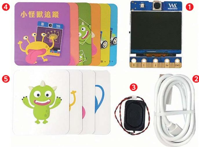
Web:AI 開發板使用 K210 AI 晶片以及 ESP8285 Wi-Fi 晶片，能夠做出「人臉追蹤、影像分類、物件追蹤、語音辨識、QRCode 掃描…」等應用，支援 Python 和 Tensorflow 訓練模型，只需要一塊板子就能夠讓**人工智慧 (AI)** 與**物聯網 (IoT)** 結合成**智慧物聯網 (AIoT)** 融入生活，可以離線執行，其產品包括：
