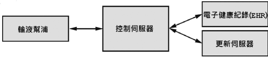
圖 2-2：輸液幫浦及其控制伺服器的擴展架構圖，伺服器還連接到 EHR 和更新伺服器
