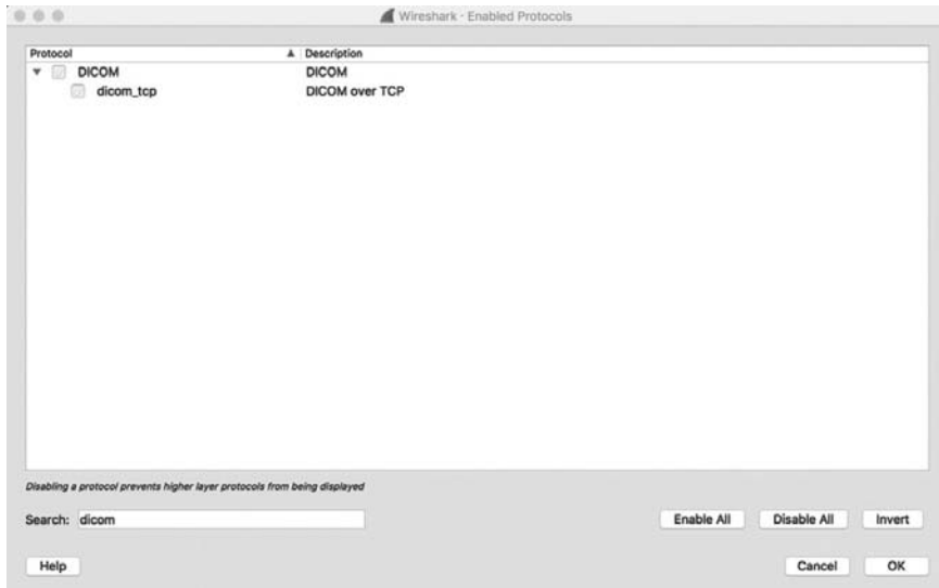
圖 5-2：Wireshark 的 Enabled Protocols 視窗中被停用的協定解剖器
