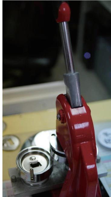
2. 先將列印輸出的彩圖以直徑 68mm 刀模鋸形後放入模具孔槽疊於胸針或開罐器背模上，最後疊上直徑 68mm 的透明塑膠片。
