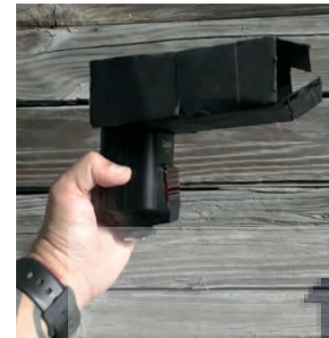
圖 2.25 | 當我需要替閃燈裝上葉片式擋光板，卻找不到現成品時，就自己利用黑色泡棉板以及大力膠帶自製了一個。
