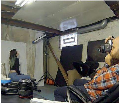
圖 2.36 | 照片中可以看到我自製的 24 英寸長束光筒，前方還有加一塊形狀片。這種加長的束光筒，打出來的光帶邊緣分界，比之前使用較短的葉片擋光板更加清楚，這是因為光源到形狀片之間的距離變得更長了。
