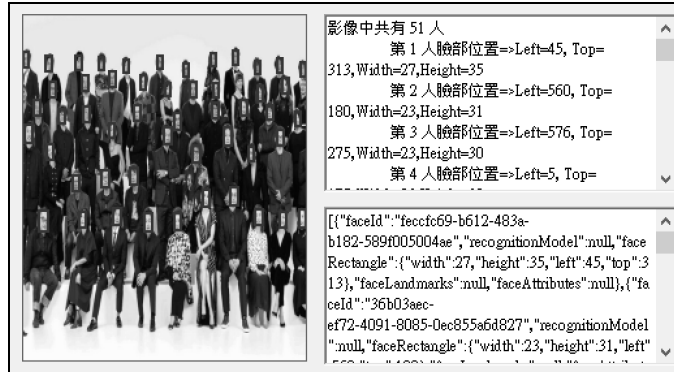
▲ 偵測出影像中有多少張臉，及每一張臉部矩形週框的座標和大小
