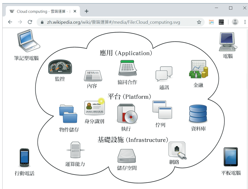
圖8.8 雲端運算示意圖 (圖片來源：維基百科CC-BY-SA 3.0 Sam Johnston)
