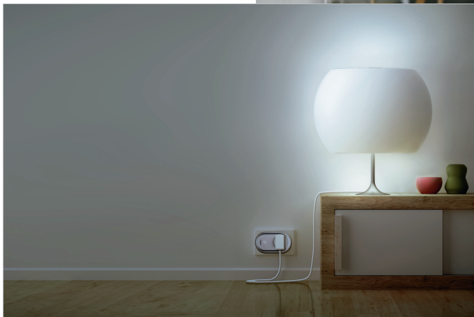
圖8.14 (a) 智慧管家只要搭配智慧周邊裝置，即可監控家裡掌握最新狀態 (b) 智慧門鎖支援密碼解鎖、NFC解鎖、遠端解鎖及鑰匙解鎖 (c) 智慧插座可以遠端遙控開關電器並監控電量 (圖片來源：ASUS)
