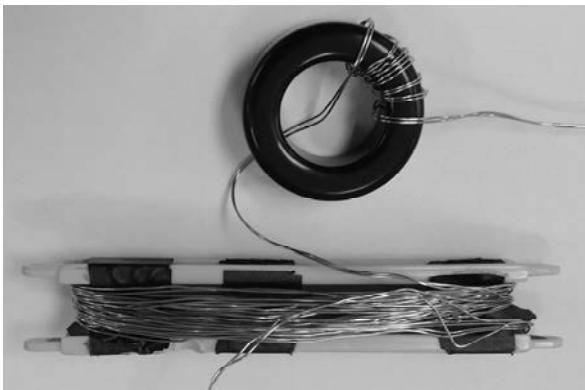
圖 4-12 電感器繞製過程
