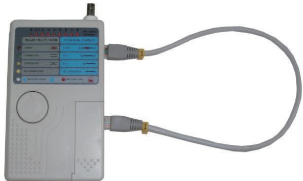
用網路線測試器測量是否 8 芯線都導通
