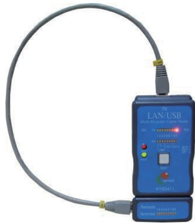
用網路線測試器測量是否 8 芯線都導通
