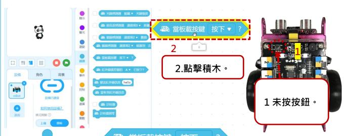
**圖**。當板載按鍵 按下 ▼ 1. 點選偵測,拖曳積木 ,在未按下mBot按鈕時點擊積 木,檢查積木顯示的執行結果為何?
