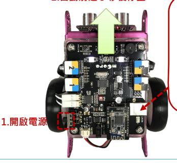
拔除電腦與 mBot 連接的 USB,只要 開啟電源,mBot 不 需要連接電腦,就能 夠執行寫入的程式。
