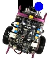
(2) 讓 mBot 右偏,將右邊放在白線上,讓「Sensor 2」 亮燈,拖曳下圖積木,點擊積木,檢查循線感測器的 執行結果為: true 。
