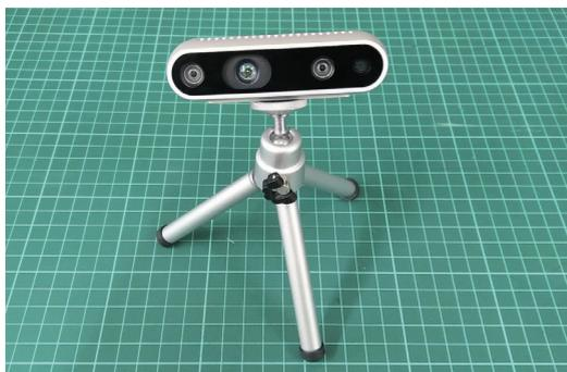
圖 4-1 Intel RealSense D435 景深攝影機
