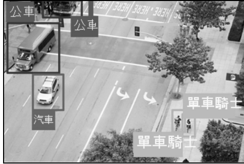
▲ 使用物件偵測取得公車、計程車、單車騎士在影像中的位置 (圖片取自 Microsoft 技術文件網站)
