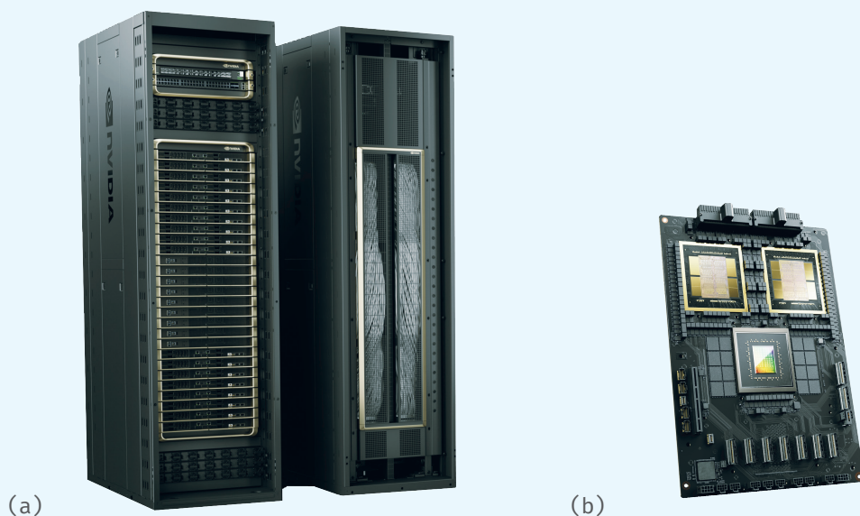
圖 1.8 (a) GB200 NVL72 AI 伺服器 (b) Blackwell GPU (圖片來源：NVIDIA)
